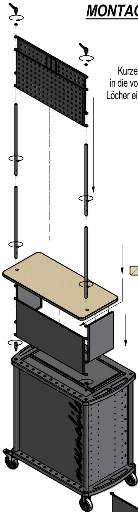
1. Kurze Stangen in die vorhandenen Löcher einschrauben.
